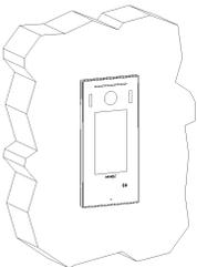
Die Hohlraummontage erfolgt analog der Unterputzmontage für die Innenanwendung. Ein Wanddurchbruch mit den Maßen 183 x 83 mm ist herzustellen.
