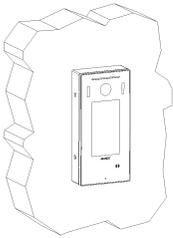
Die Aufputzmontage erfolgt analog der Unterputzmontage für die Innenanwendung, es ist kein Wanddurchbruch herzustellen. Das Gerät wird direkt auf die Wand aufgeschraubt. Das Rückteil besteht zusätzlich aus dem vormontierten Schmuckrahmen.
