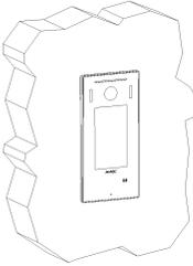
Das Gerät hat die Abmessungen 95 (Breite) x 197 (Höhe) und eine Gesamttiefe von 36 mm. Ein Wanddurchbruch mit den Maßen 183 x 83 mm ist herzustellen.
