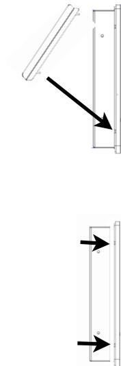
1 Mit Entriegelungsblechen Front vom Rückgehäuse lösen: dazu jeweils links und rechts die Bleche mit den Nasen in die jeweiligen Öffnungen einsetzen und drücken, bis das Frontteil sich löst.
